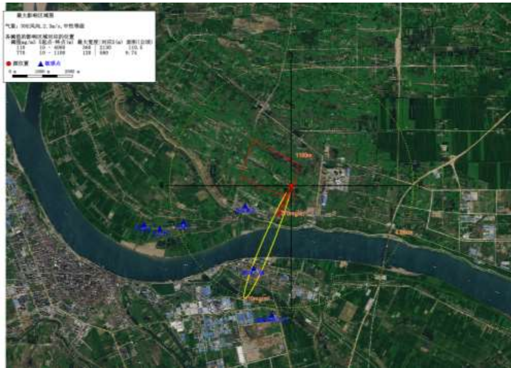
图 6.7-6 最常见气象条件下液氨储罐泄漏最大影响范围图
