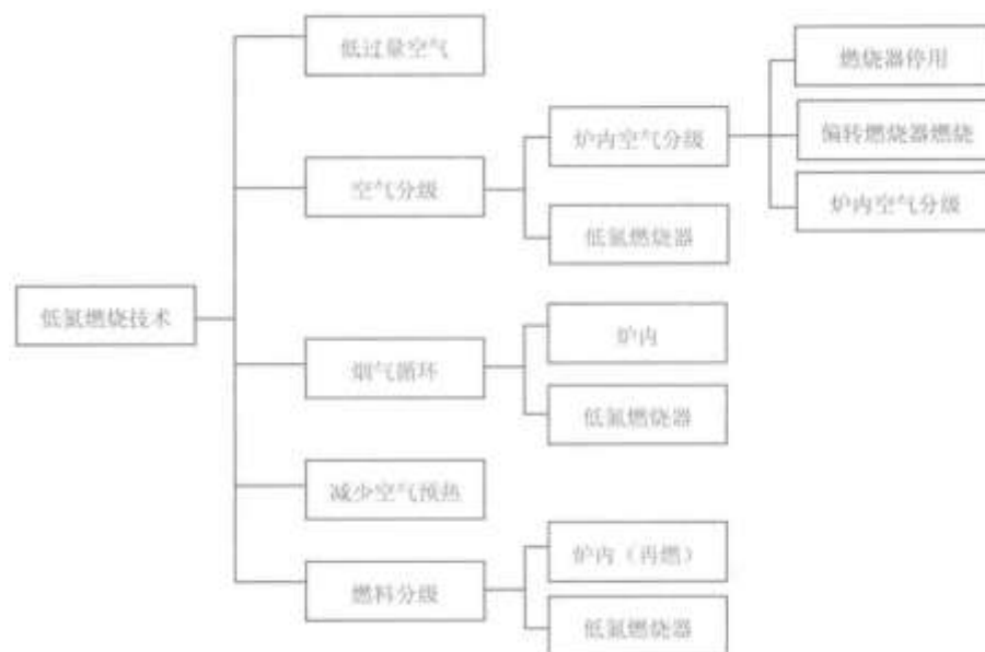
图 7.2-9 高效低氮燃烧技术分类
