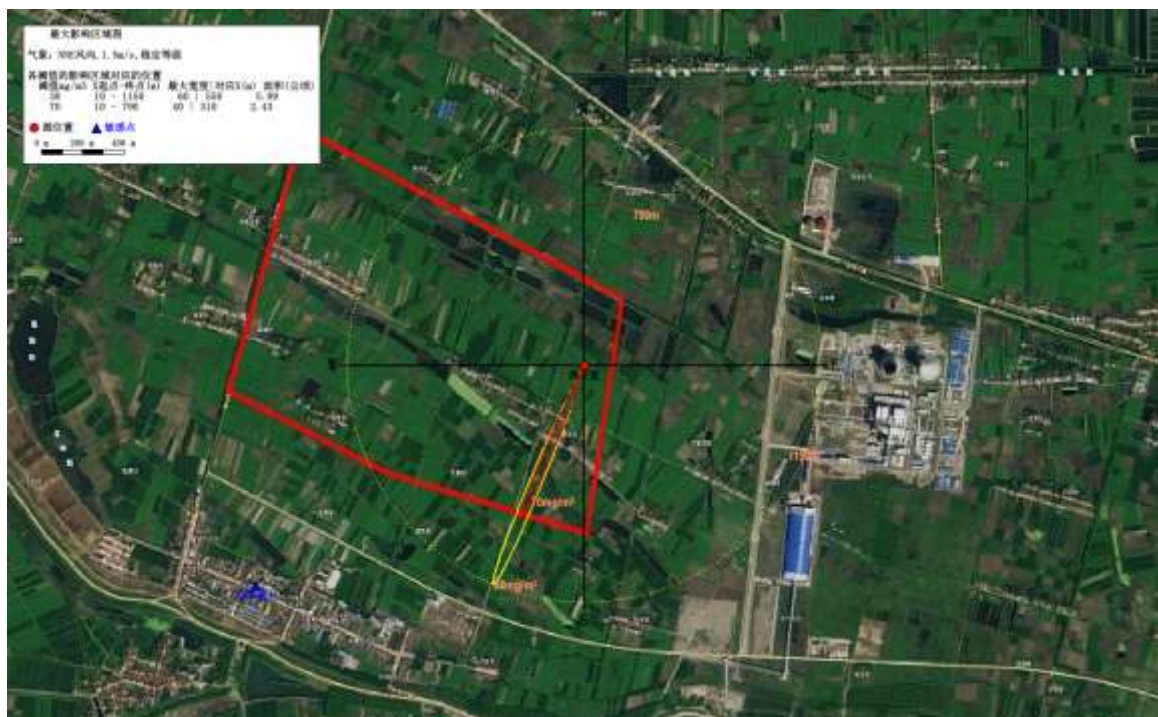
图 6.7-3 最不利气象条件下合成气 (H 2 S) 泄漏最大影响范围图
