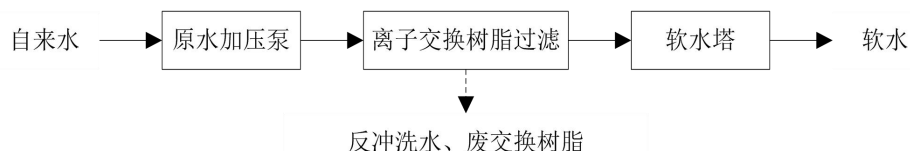
图 2.3-7 软水制备工艺流程及排污节点图
